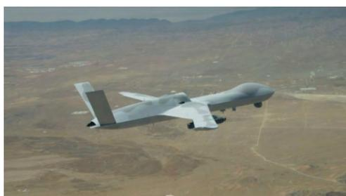
图5 MQ-20无人机配装“天空博格人”自主控制系统
